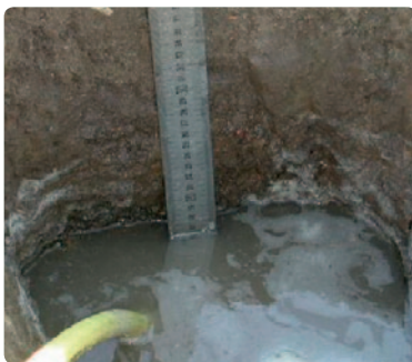
Synkehastighed måles. Hvis vandspejlet synker mindre end 0,2 m på 15 min. kan infiltrationstesten begynde.
