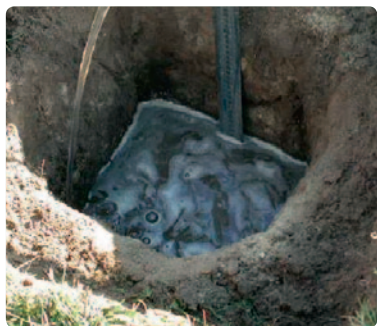
Hullet holdes fyldt i ca. 30 min. I våde perioder (med meget regn) kan dette nedsættes til 15 min.
